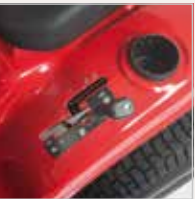
6 VITESSES AVANT ET ARRIÈRE SUR MODÈLES À TRANSMISSION TRANSMATIC
