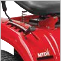
AJUSTEMENT DE LA HAUTEUR DE COUPE ET EMBRAYAGE DES LAMES MANUEL
