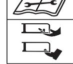
Før innstilling eller rengjøring av maskinen, eller før maskinen kontrolleres, må den slås av og tennpluggkontakten må trekkes av.
