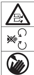
Perigo de lesão devido às lâminas ou peças rotativas. Não colocar as mãos nem os pés em aberturas com a máquina em funcionamento.
