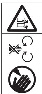
Risque de blessures par des couteaux ou pièces en rotation. Ne jamais garder les mains et les pieds dans les orifices lorsque la machine fonctionne.
