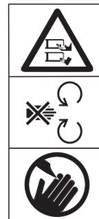
Risk för personskador på grund av roterande knivar eller delar. Stick inte in händer och fötter i maskinens öppningar när den är igång.
