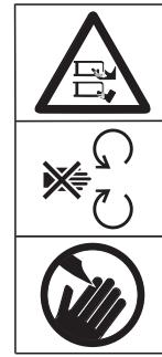
Fare for skade på grunn av roterende kniver eller deler. Hender og føtter må ikke holdes inn i åpningene når maskinen er i gang.
